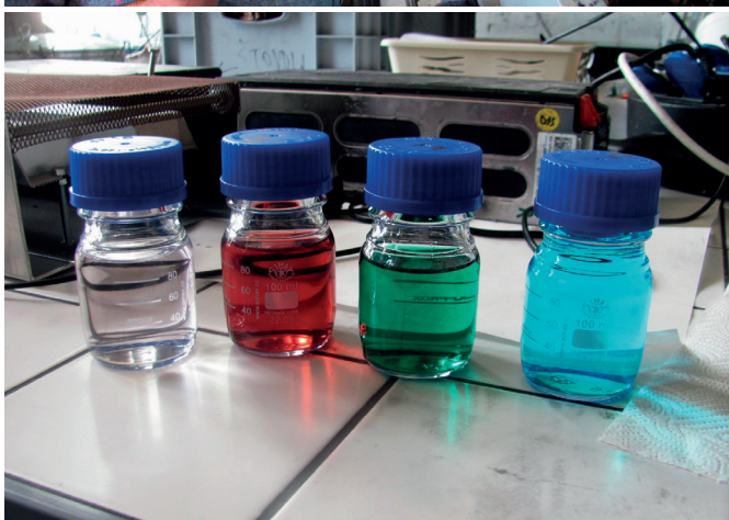
Takto to začíná... Profesor Pavel Janoš u částečně rozebrané, rozemleté lithiové baterie (nahore). ... a takto to končí. Roztoky čistých kovů z baterií – účinnost recyklace kovů by měla být až 90 % (dole). Foto: Břetislav Koč
