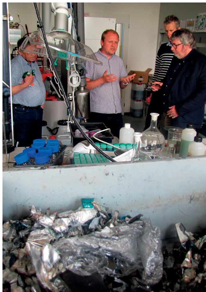
Pohled na část kolony k naplnění ionexem (měničem iontů) pro zachycení a selektivní separaci kationtů niklu, kobaltu, manganu a lithia od balastních látek. V popředí rozemletá lithiová baterie. Za kolonou – prof. Pavel Janoš a doc. Jiří Orava – FŽP UJEP, Vladimír Vojtěch a Daniel Frank – TC Praha. Foto: Břetislav Koč
