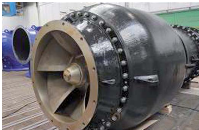
Funkční vzorek čerpadla s potlačenou vstupní recirkulací (vlevo) a odvozené produkční čerpadlo pro čerpací stanice v Egyptě (vpravo)
