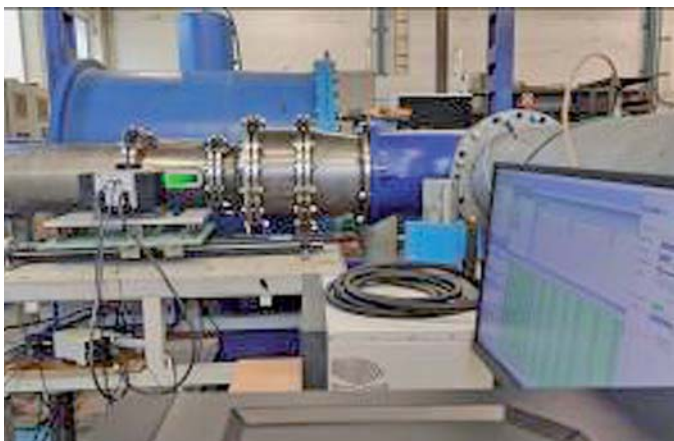
Funkční vzorek čerpadla s potlačenou vstupní recirkulací (vlevo) a odvozené produkční čerpadlo pro čerpací stanice v Egyptě (vpravo)
