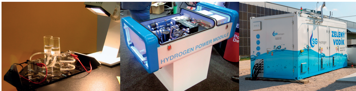
Přesně podle Komenského – od jednoduchého po složitější: Od školního demonstračního modelu elektrolyzéru produkujícího vodík k malému komerčnímu elektrolyzéru s výkonem 15-45 kW a k průmyslovému elektrolyzéru s produkcí 82 kg vodíku za den. Foto B. Koč (1, 2), SG Hydrogen Napajedla (3)
